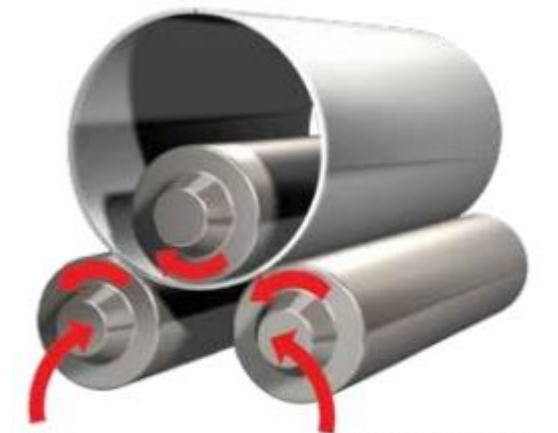
유성 롤 시스템 상부 롤: Ø200-Ø430 mm 구동: 전체 롤
