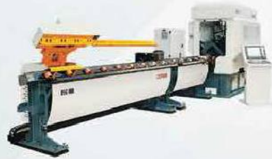
L ANGLE PROCESSING CENTER L 앵글 가공기
